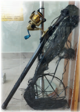
Фото. Фрагмент поврежденного углепластикового удилища с места несчастного случая, который произошел по причине приближения удочки на недопустимое расстояние к высоковольтному проводу воздушной линии электропередачи напряжением 110 кВ.
